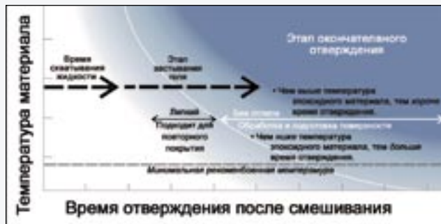
Рис.1. По мере отверждения, смешанный эпоксидный материал переходит из жидкого состояния в состояние гелевой массы, а затем – в твердое вещество.
