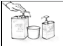
Рис. 2. Дозировка полимерного материала и отвердителя.
