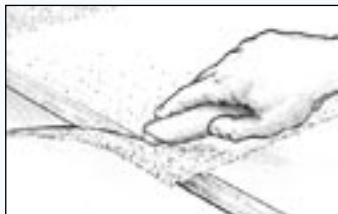
Рис. 25. Обрежьте лишнюю ткань после того, как эпоксидный материал превратится в гель, но до полного отверждения
