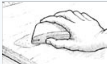
Рис. 23. Отшлифуйте застывший материал так, чтобы добиться необходимого контура
