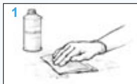
Рис. 6. Очистите поверхность. При необходимости используйте растворитель для устранения всех загрязнений.
