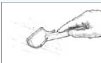
Рис. 31. Разровняйте покрытие при помощи поролонового валика (по незастывшему эпоксидному материалу)
