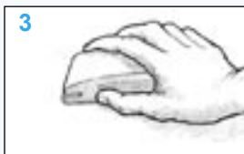
Рис. 8. Отшлифуйте непористую поверхность. Создайте текстуру для того, чтобы эпоксидный материал мог прикрепиться к ней.
