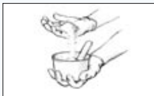
Рис. 4. Добавьте наполнитель в небольшом количестве так, чтобы достичь нужной консистенции.
