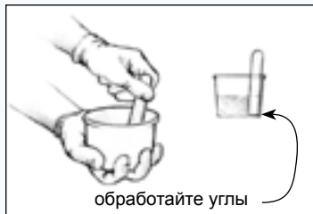
Рис. 3. Тщательно перемешивайте оба ингредиента на протяжении 2 минут или дольше при низких температурах.
