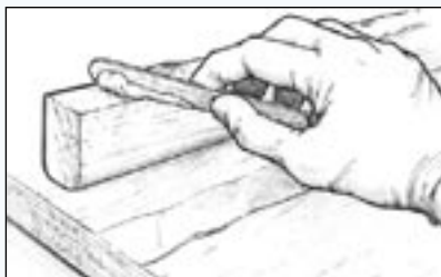
Рис. 10. Нанесите загущенный эпоксидный материал на одну из склеиваемых поверхностей.
